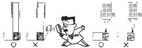
9 連接配管時請以適當的扭力鎖緊固定。
